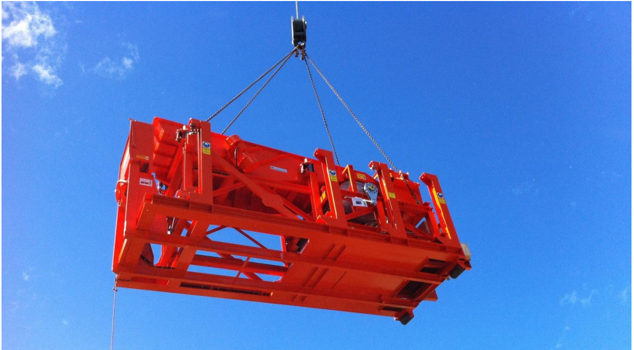
Abladen der semi-mobilen Sortieranlage beim Kunden
